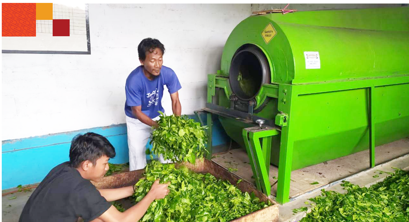
Proses pelayuan teh paninggaran menggunakan mesin pelayuan bersuhu 70-80 derajat celsius. ▲
