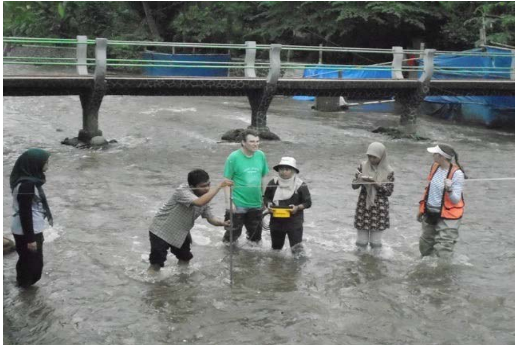
Mengukur Debit Air pada Sungai
